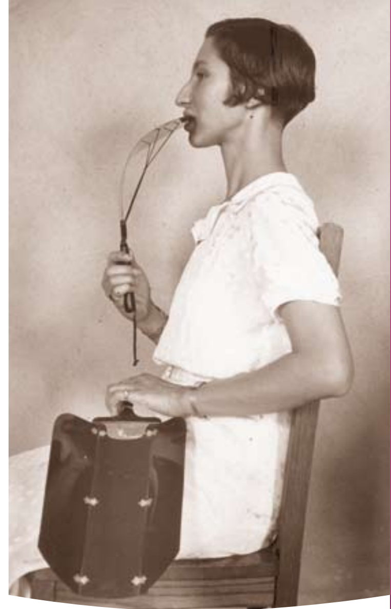
ca. 1920. Demonstratie van de 'Rhodes Audiphone'. Dit beengeleidings-toestel gaf een versterking tot 30 dB, mits de gebruiker een gezond en sterk gebit had
